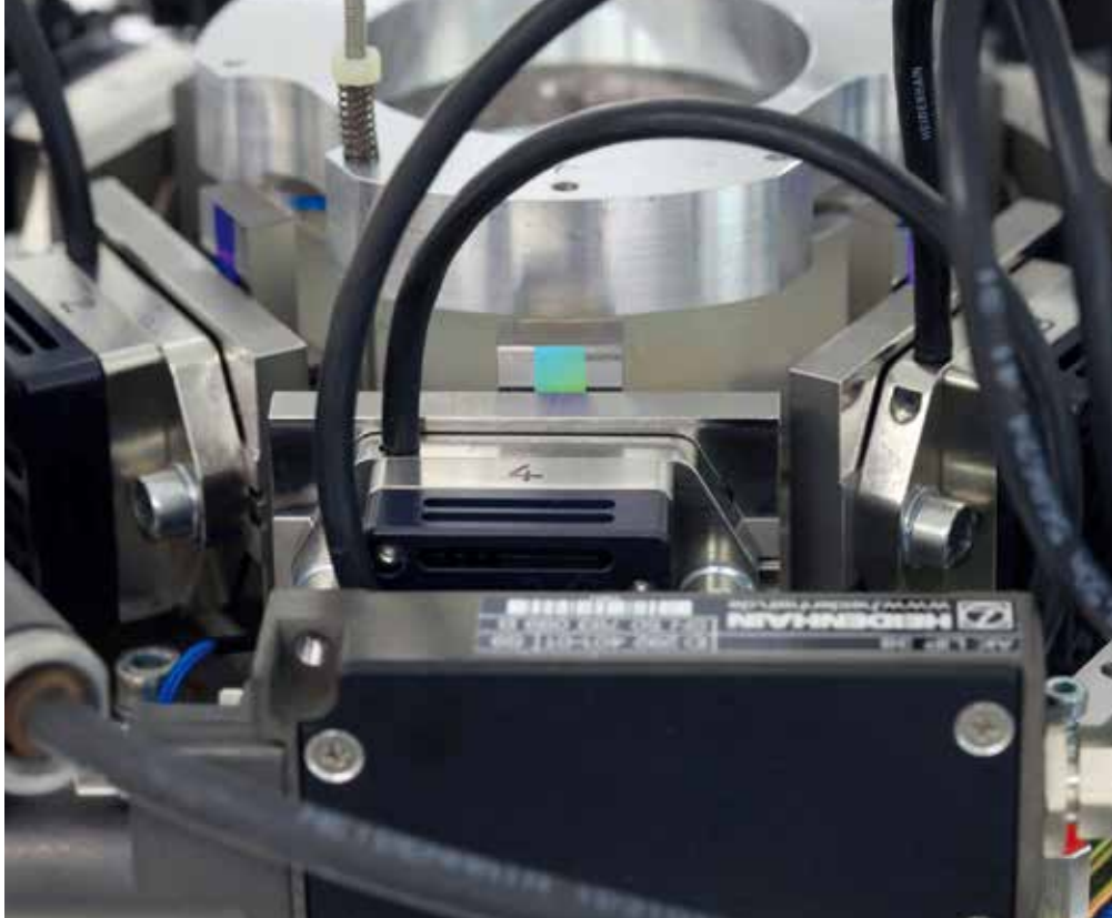
各面向的編碼器：海德漢6支直線編碼器圍繞安裝在濾波器的玻璃板上。
