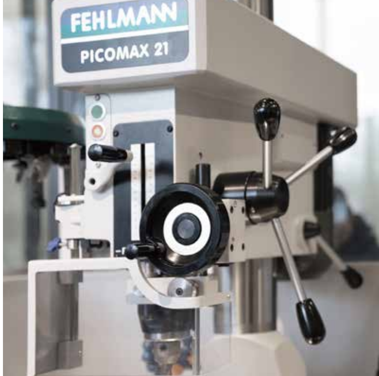
手動操作機台加裝電動工作台和POSITIP 8000 ACTIVE：FEHLMANN PICOMAX 21-M可取代傳統CNC機台。
