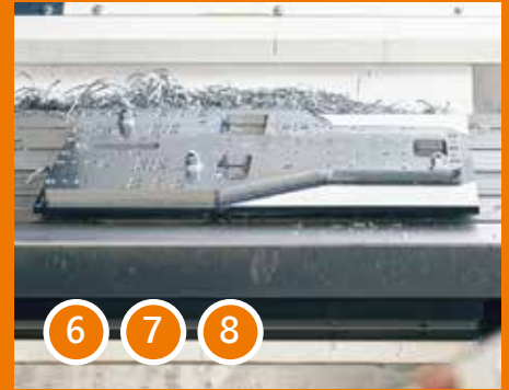
6 包括鑽孔裝埋的貫穿孔鑽孔 7 M5與M8攻牙 8 生產H7鉸孔，進行重複工作的精確定位
