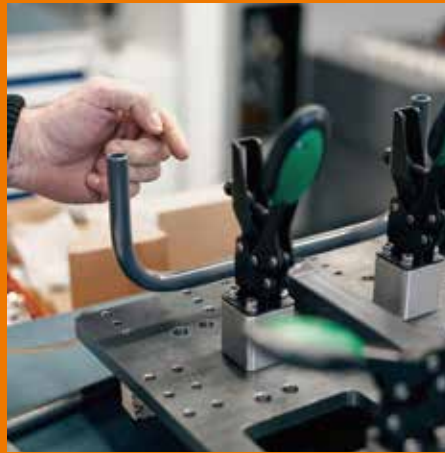
用剪切鉗和插入的安裝單元測試焊接模板的組裝。
