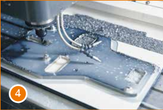
4 外輪廓已銑削，去除多餘和滲碳的邊緣區域。基材上的凹槽不是故意以電漿切割。無法避免因熱導致翹曲變形。
