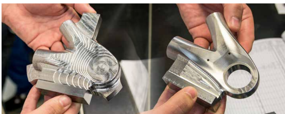
В два шага к идеальной детали: шарнир подвески после черновой обработки (слева), после чистовой обработки (справа).
