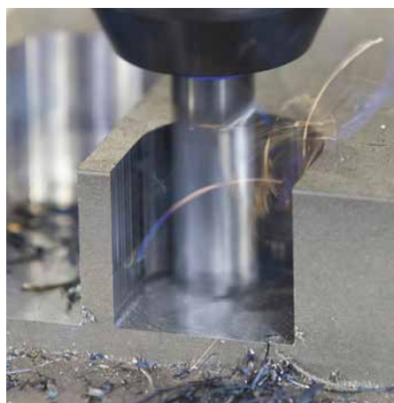
Быстрый сьем материала – в трохоидальном фрезеровании на линейную подачу накладывается круговое движение.
