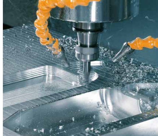
Быстро и эффективно: для достижения больших объемов снимаемой стружки при черновой обработке.
