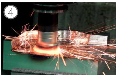
После следующих 72 минут без AFC: Обработка продолжилась до раскаления инструмента и заготовки.
