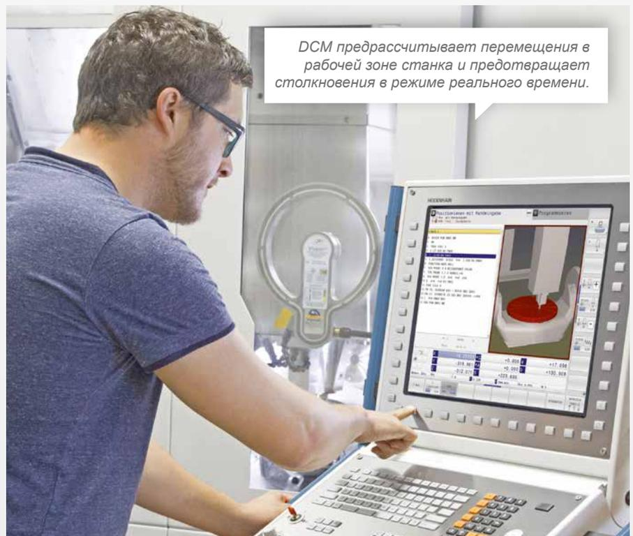
*DCM предрассчитывает перемещения в рабочей зоне станка и предотвращает столкновения в режиме реального времени.*
