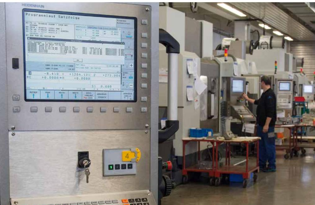
контрольные задания - постоянная составная часть отработки программ. Программы сгенерированные в CAD/CAM-системах также нуждаются в оригинальных измерительных циклах HEIDENHAIN, чтобы гарантировать одинаково высокое качество обработки при помощи автоматизированных измерений.
