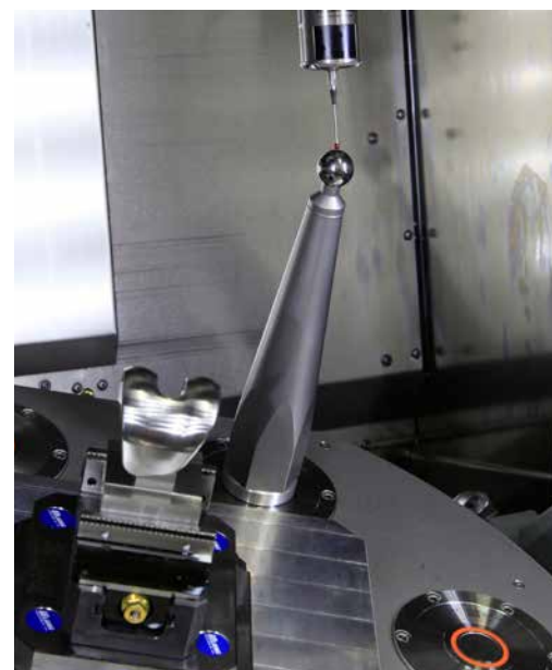
Calibrazione più precisa con 3D-ToolComp e ciclo di tastatura 444.
