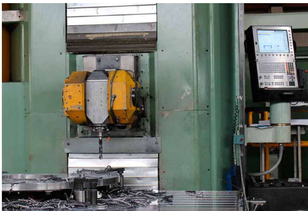
Il retrofit con TNC 320 HEIDENHAIN assicura una maggiore velocità di esecuzione dei blocchi per i programmi da CAD.
