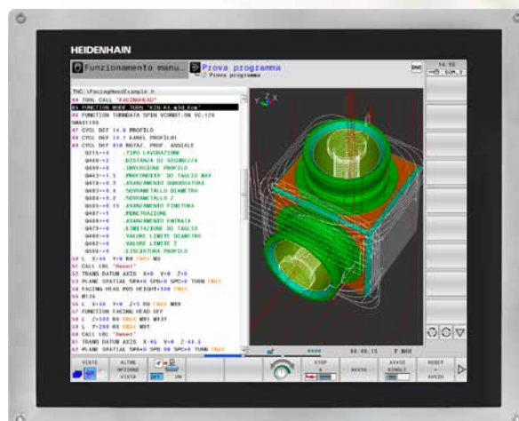
Simulazione della lavorazione di tornitura con testa a sfacciare nel piano ruotato
