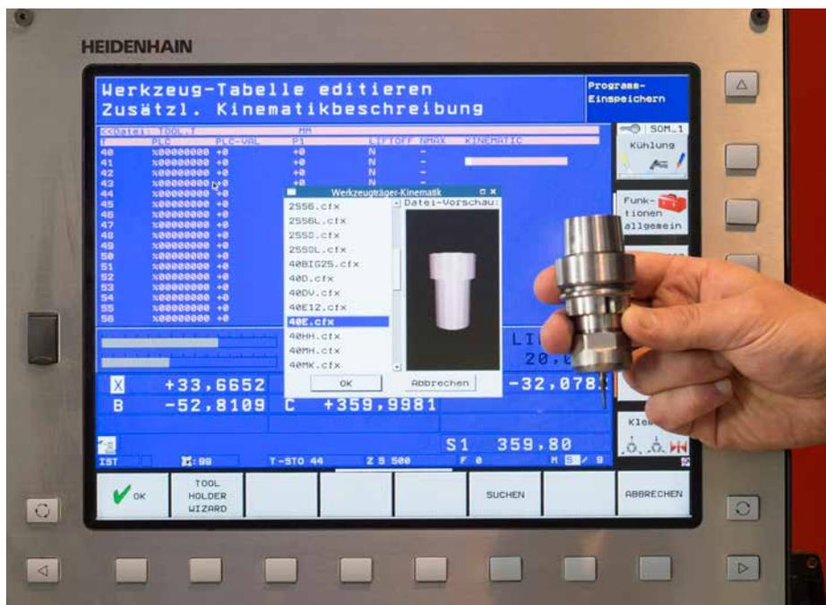
Una soluzione globale: il controllo anticollisione DCM considera oltre ai componenti fissi della macchina anche gli utensili e i portautensili...
