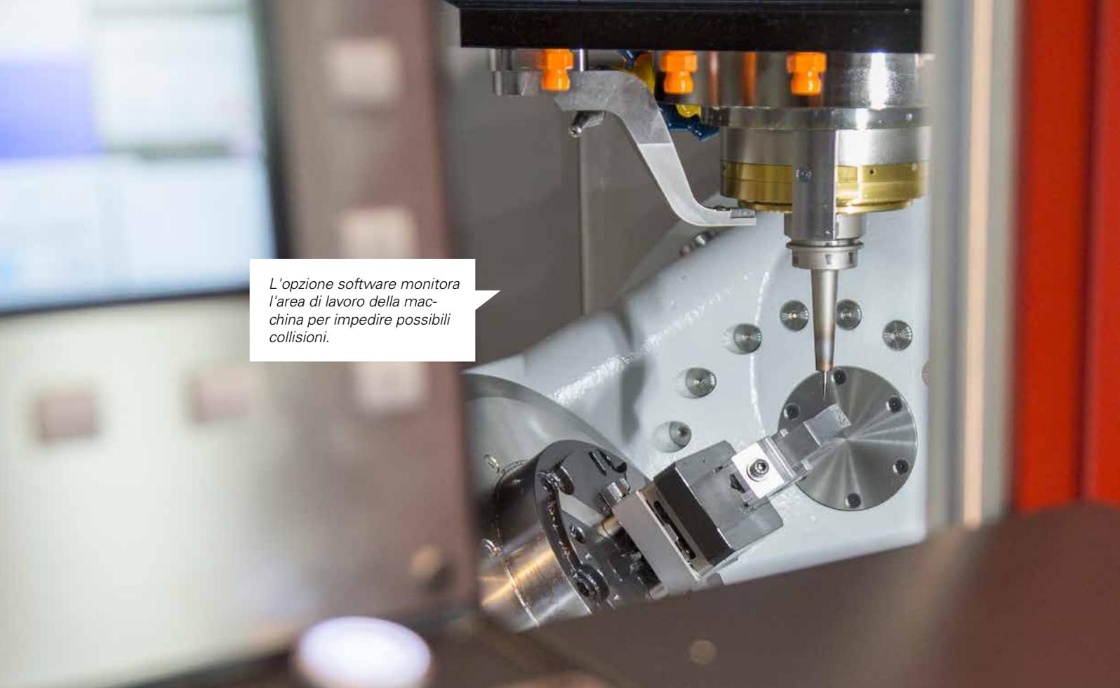
L'opzione software monitora l'area di lavoro della macchina per impedire possibili collisioni.
