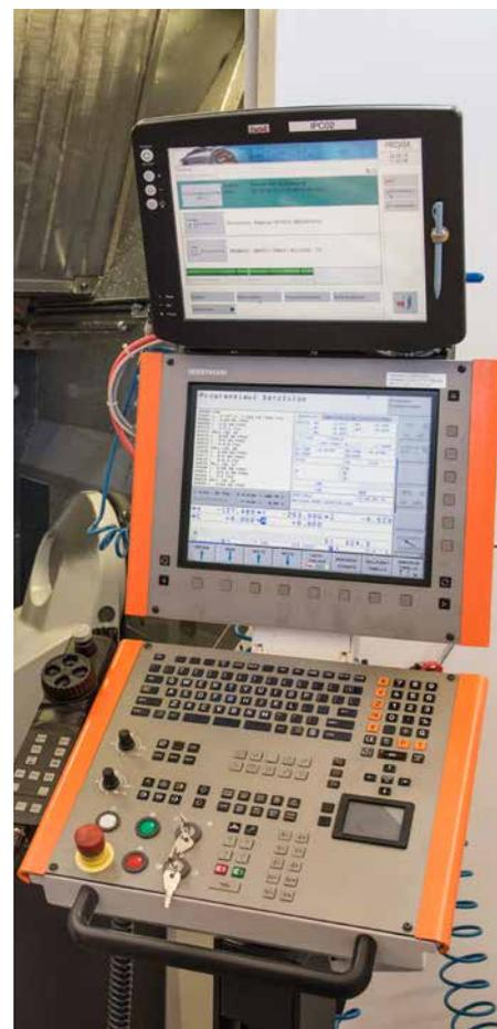
iTNC 530 e Shop Floor Management sono collegati direttamente tra loro per il rilevamento automatico dei dati macchina.
