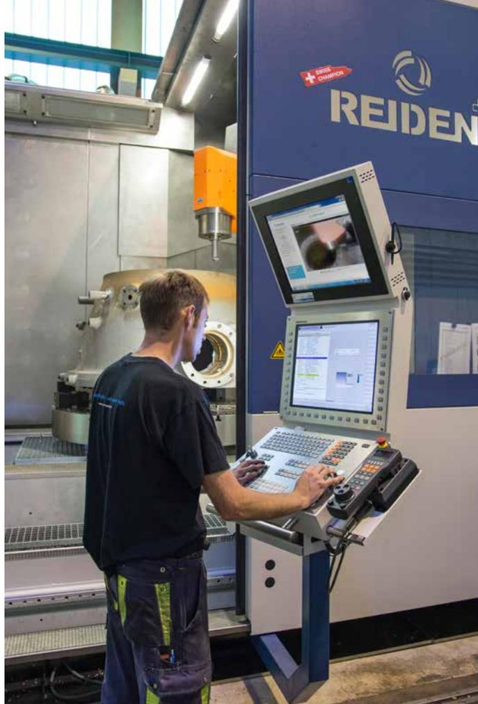
*Investimento sicuro: Grimsel Hydro si occupa dell'ammodernamento di centrali idroelettriche. Con il nuovo centro di lavoro a 5 assi REIDEN RX 18 e il controllo numerico HEIDENHAIN TNC 640 è perfettamente equipaggiata per il futuro.*
