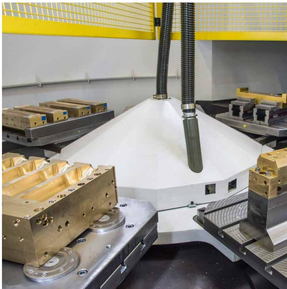
Cambio pallet compatto e facilmente accessibile di GF Machining Solutions.
