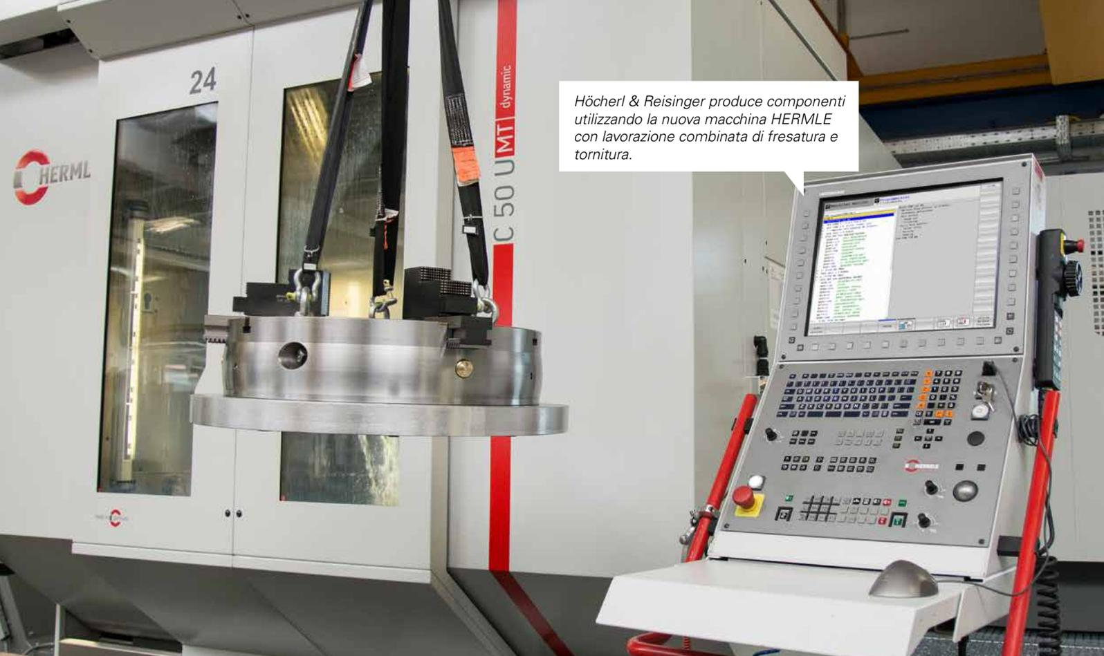
Höcherl & Reisinger produce componenti utilizzando la nuova macchina HERMLE con lavorazione combinata di fresatura e tornitura.
