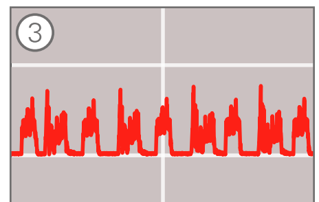
3 Au bout de 58 minutes, avec l'AFC : Puissance de la broche au moment de l'interruption de l'usinage par la fonction AFC
