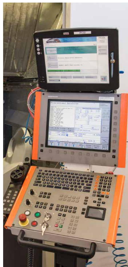
Pour l'acquisition des données machine, l'iTNC 530 est directement reliée au système de gestion de l'atelier.
