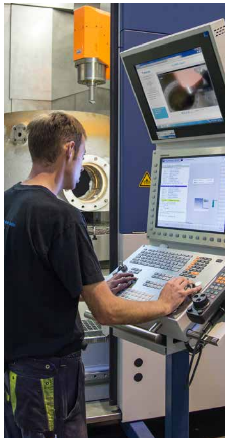
La TNC 640 est la commande la mieux adaptée pour un usinage intégral hautement précis dans l'atelier de maintenance Grimsel Hydro.
