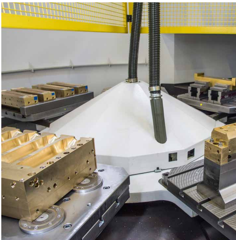
Le changeur de palettes de GF Machining Solutions est compact et facile d'accès.
