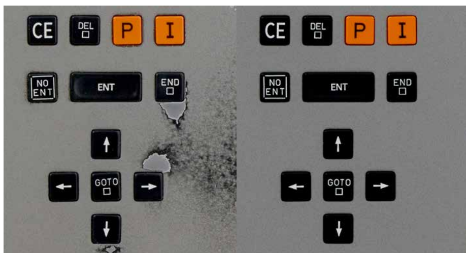
Le client a le choix : dans tous les cas, la réparation fonctionnelle (à gauche) tout comme la réparation premium (à droite) sont irréprochables d'un point de vue technique.
