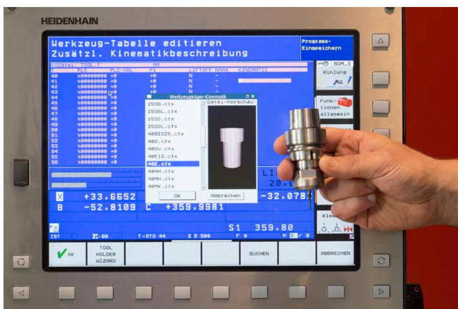
La fonction de contrôle anti-collision DCM est une solution complète qui tient non seulement compte des composants fixes de la machine, mais également des outils, des porte-outils...
