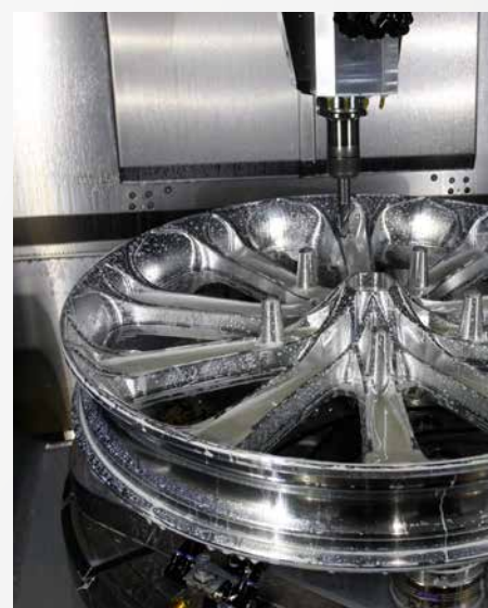
La roue de l'Unbreakable est simulée en 3D avant d'être fraisée à partir d'une masse d'aluminium (monobloc).
