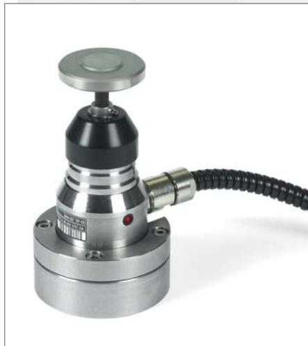
commutation généré par le commutateur optique intégré est transmis à la CN. Celle-ci compense l'usure en conséquence. Sans intervention manuelle et avec le TT 140, la CN détermine ainsi entièrement automatiquement la longueur et le rayon effectifs
