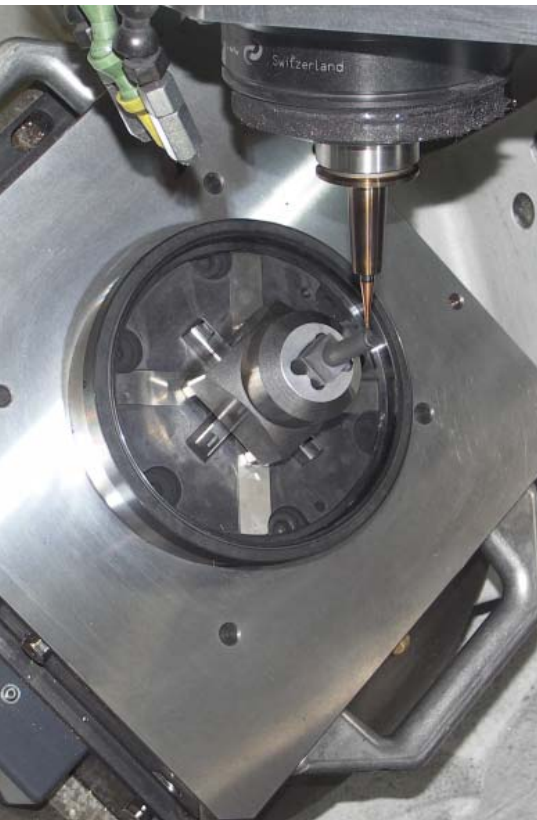
Una vista en la sala de máquinas: fresado HSC preciso
