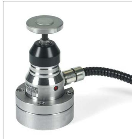
La herramienta, girando o en reposo, inclina el elemento de palpación del TT. Mediante un conmutador óptico integrado se genera una señal de conmutación que se transmite al CNC. Aquí se compensará el desgaste correspondientemente.
