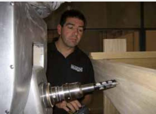
*Gert van de Pol, tecnico CAD/CAM, si concentra sull'avvicinamento della fresa mediante volantino...*
