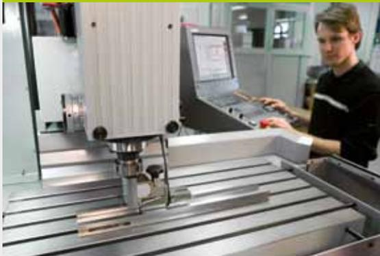
Il nostro reparto di assistenza è in grado di determinare lo scostamento dinamico e statico dei movimenti della vostra macchina utensile.
