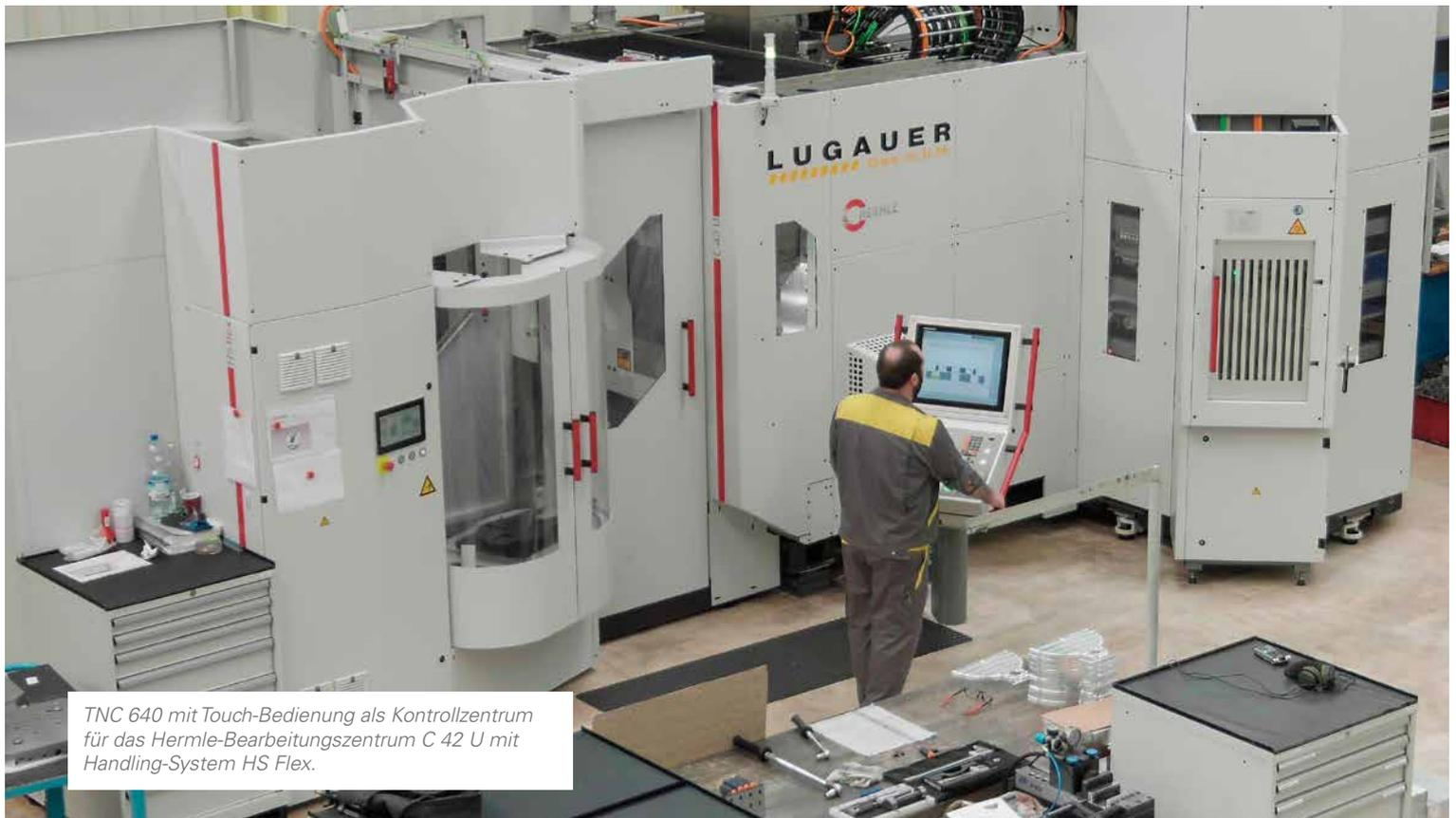
*TNC 640 mit Touch-Bedienung als Kontrollzentrum für das Hermle-Bearbeitungszentrum C 42 U mit Handling-System HS Flex.*
