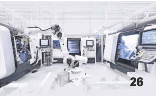
Für Handling- und Beschickungsaufgaben an der Werkzeugmaschine werden verstärkt Industrieroboter eingesetzt
