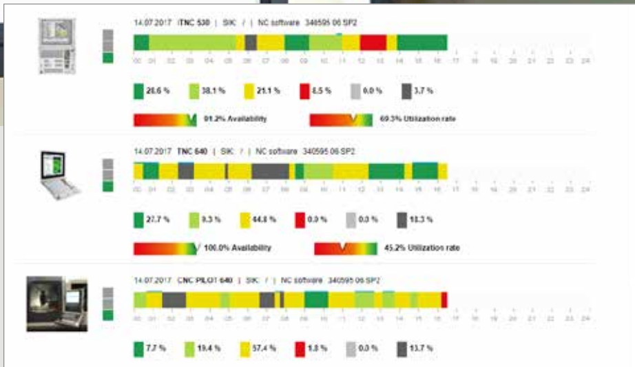
全部机床状态一目了然：“状态监控”软件显示整个机床群的可用性和利用率。
