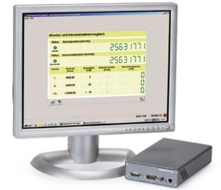
Das Phasenwinkelmessgerät PWM 9 kann in Reihe zwischen Messgerät und Folge-Elektronik geschaltet werden. Die Funktionalität gliedert sich in PWT-Mode und PWM-Mode.
