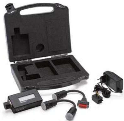
Mit dem PWT steht eine einfache Einstellhilfe für die inkrementalen Messgeräte von HEIDENHAIN zur Verfügung. In einem kleinen LCD-Fenster werden die Signale als Balkendiagramme mit Bezug auf ihre Toleranzgrenzen angezeigt.
