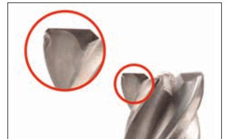
在加工两件后的刀具
