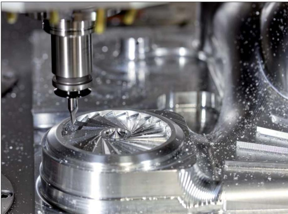
通过显著降低高速执行NC程序期间刀具中心点的误差，**动态高精**能为机床性能的提升发挥重大作用。
