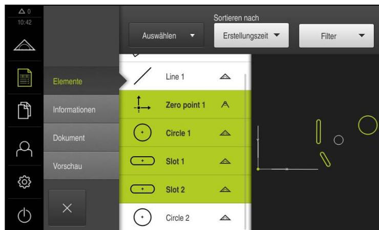
Abbildung 27: Menü **Messprotokoll** mit Elementeliste und Elemente-Ansicht
