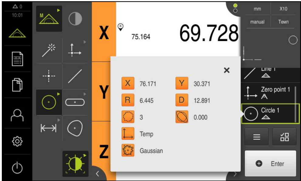
图 57: 圆几何元素，用OED测量工具获得测量点的测量结果预览
