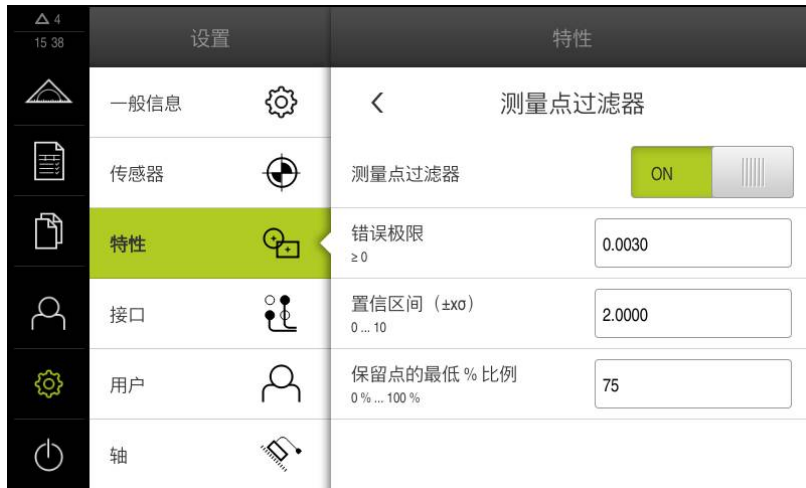
图 90: 测量点过滤器的设置
