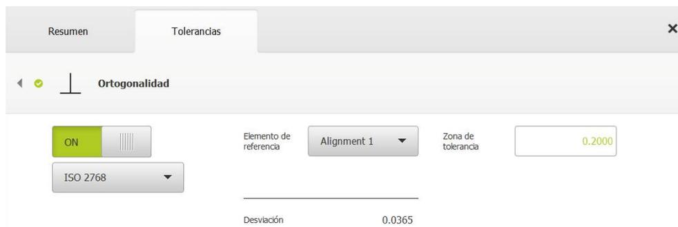
Figura 75: Resumen de **Tolerancias de dirección** con tolerancia activada **Ortogonalidad** según **ISO 2768**
