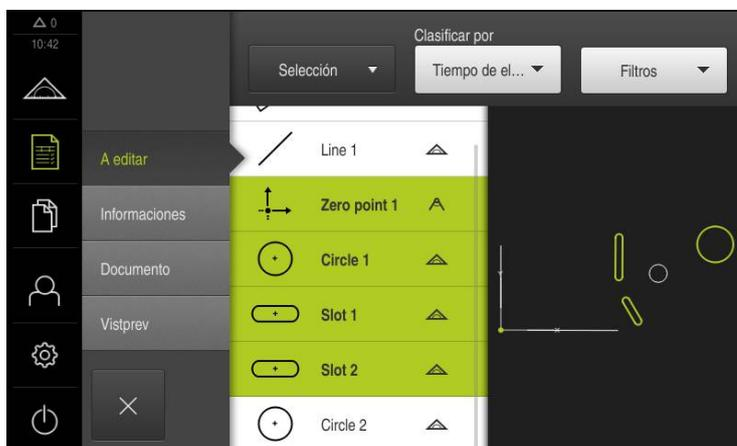
Figura 87: Menú **Protocolo de medición** con lista de elementos y vista de elementos
