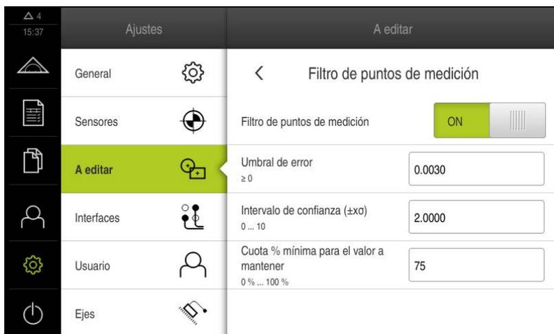
Figura 95: Ajustes del filtro de puntos de medición
