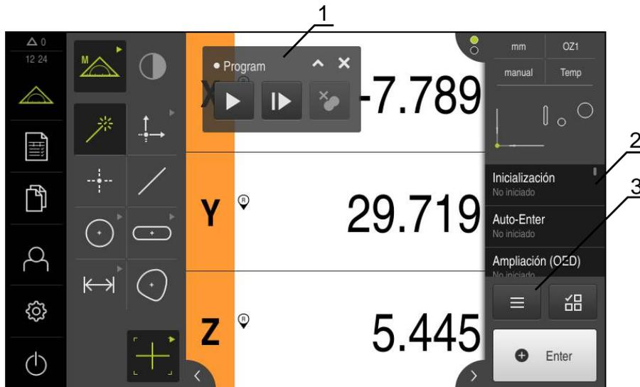
Figura 82: Elementos indicadores y de mando de los programas de medición
