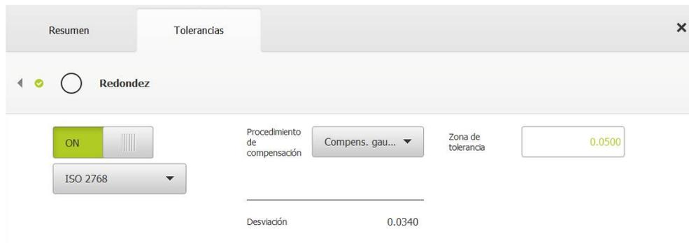
Figura 73: Resumen de **Tolerancias de forma** con tolerancia activa **Redondez** según **ISO 2768**
