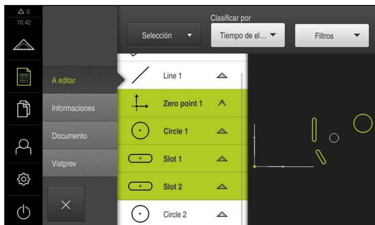
Figura 54: Menú **Protocolo de medición** con lista de elementos y vista de elementos
