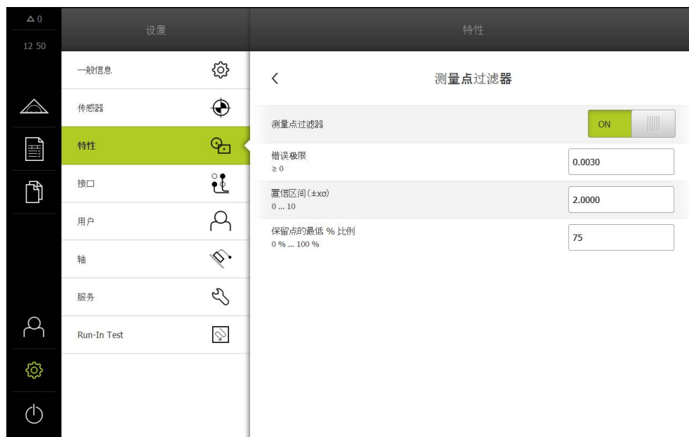
图 111: 测量点过滤器的设置
