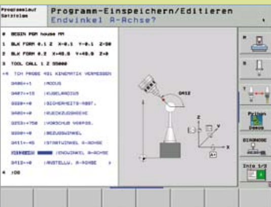
Neue Funktion KinematicsOpt: Automatische Kinematikvermessung und Automatische Nachkalibrierung der Maschinenkinematik
