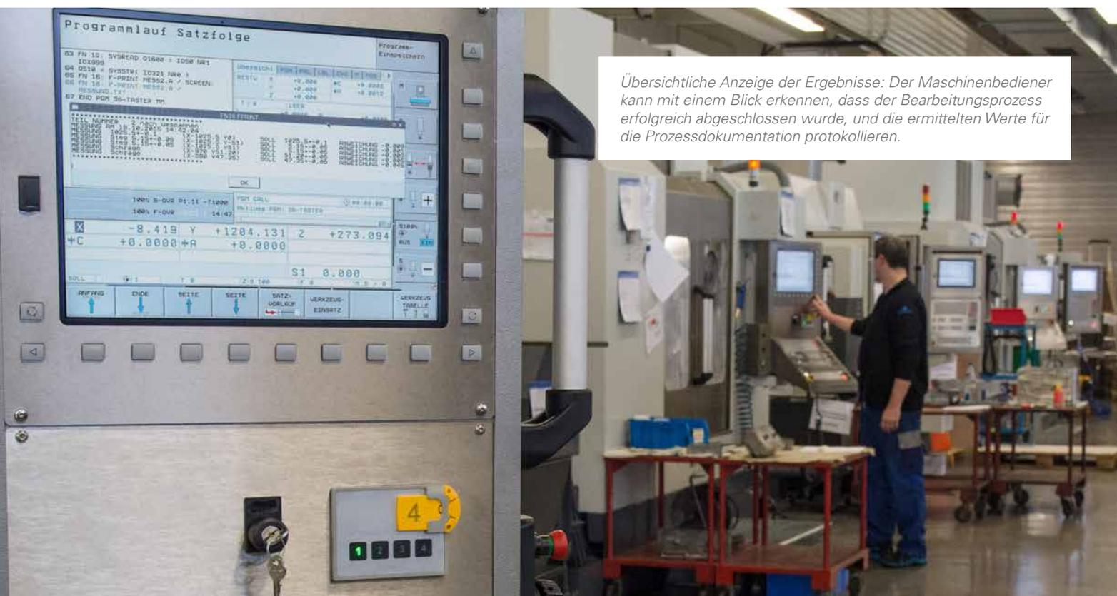
Übersichtliche Anzeige der Ergebnisse: Der Maschinenbediener kann mit einem Blick erkennen, dass der Bearbeitungsprozess erfolgreich abgeschlossen wurde, und die ermittelten Werte für die Prozessdokumentation protokollieren.
