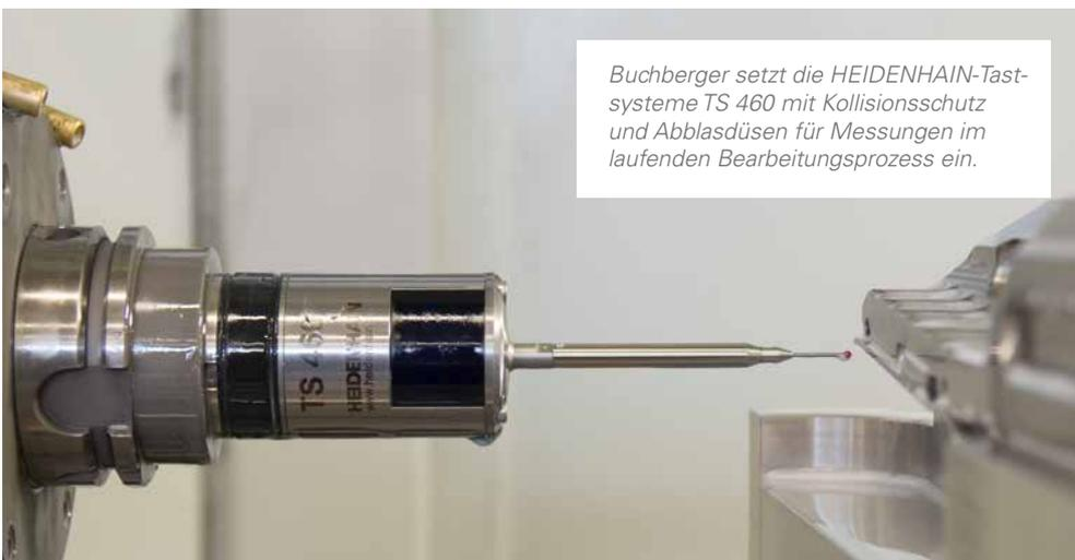
Buchberger setzt die HEIDENHAIN-Tastsysteme TS 460 mit Kollisionsschutz und Abblasdüsen für Messungen im laufenden Bearbeitungsprozess ein.
