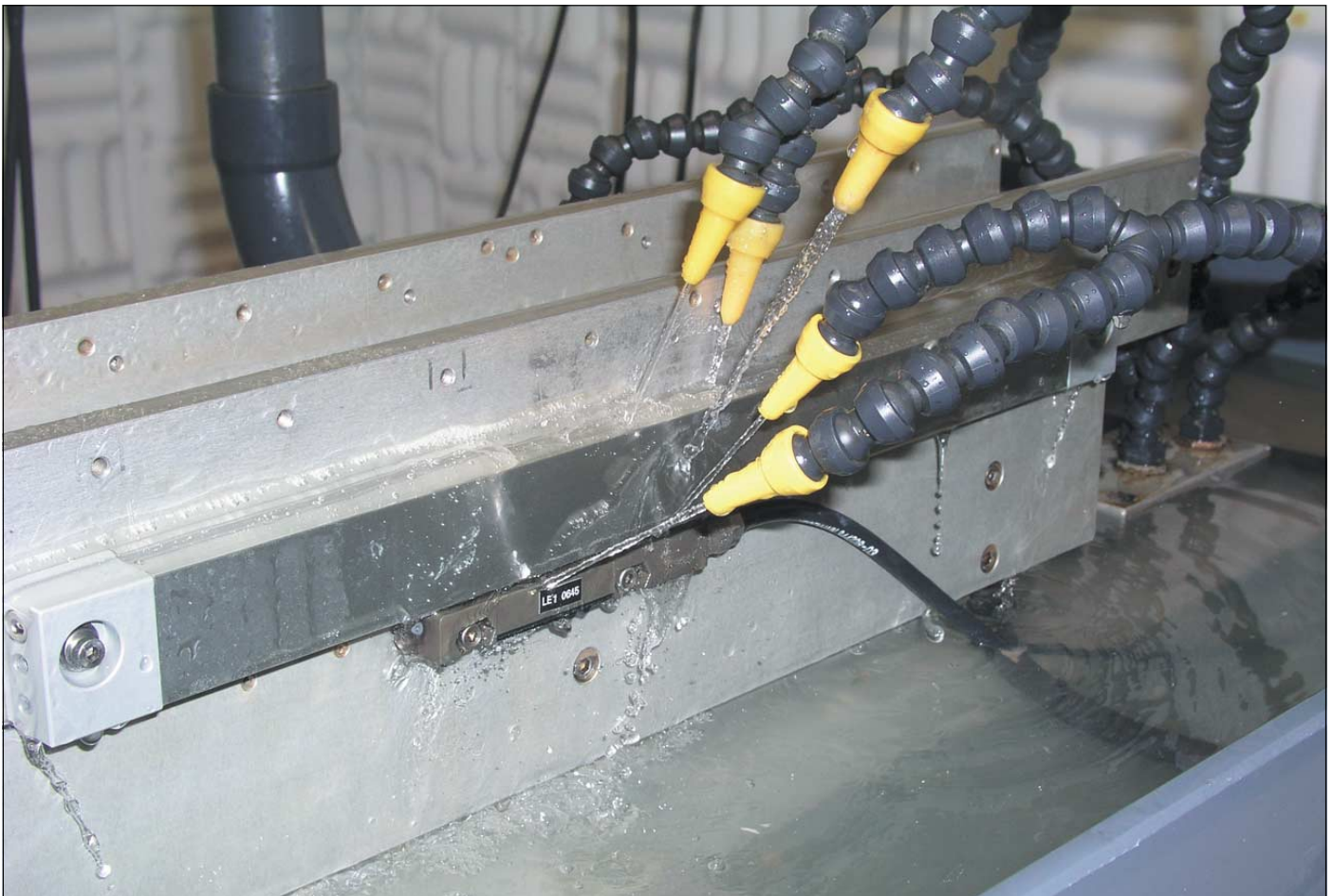
Prüfeinrichtung für Spritzwassertest mit kleinprofiligen Längenmessgerät
