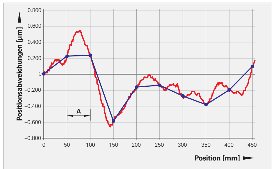
Abbildung 2: Korrekturpunkte für abschnittsweise lineare Fehlerkorrektur
